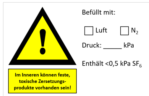
Abbildung 10: Beispiel für einen Aufkleber zur Kennzeichnung eines entleerten SF 6 Gasraums
